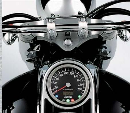
Schalten wird zur Nebensache, wenn 115 Nm aus 1462 cm<sup>3</sup> in jedem Drehzahlbereich für massig Durchzug sorgen. Trotzdem macht es die hydraulische Kupplung leicht. Dank obenliegender Nockenwelle kommt die Leistung nicht zu kurz. Mit der SACS Luft-/Ölkühlung (SUZUKI Advanced Cooling System) bleibt die C1500 cool. Für saubere Power sorgen G-Kat und SUZUKI PAIR-System, für zuverlässigen Start ohne Choke das Warmlaufsystem AFIS (Auto Fast Idle System).
