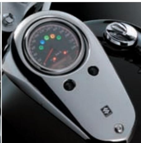
**Muskulöser Körper, fließende Linien** – Klassischer und zugleich moderner könnte ein Powercruiser gar nicht dahingleiten. Tropfentank, glänzendes Chrom. Direkt auf dem Tank sitzt das große analoge Tachoinstrument mit zwei digitalen Tripmastern, Tankanzeige, Digitaluhr und den wichtigsten Kontroll-Leuchten.
