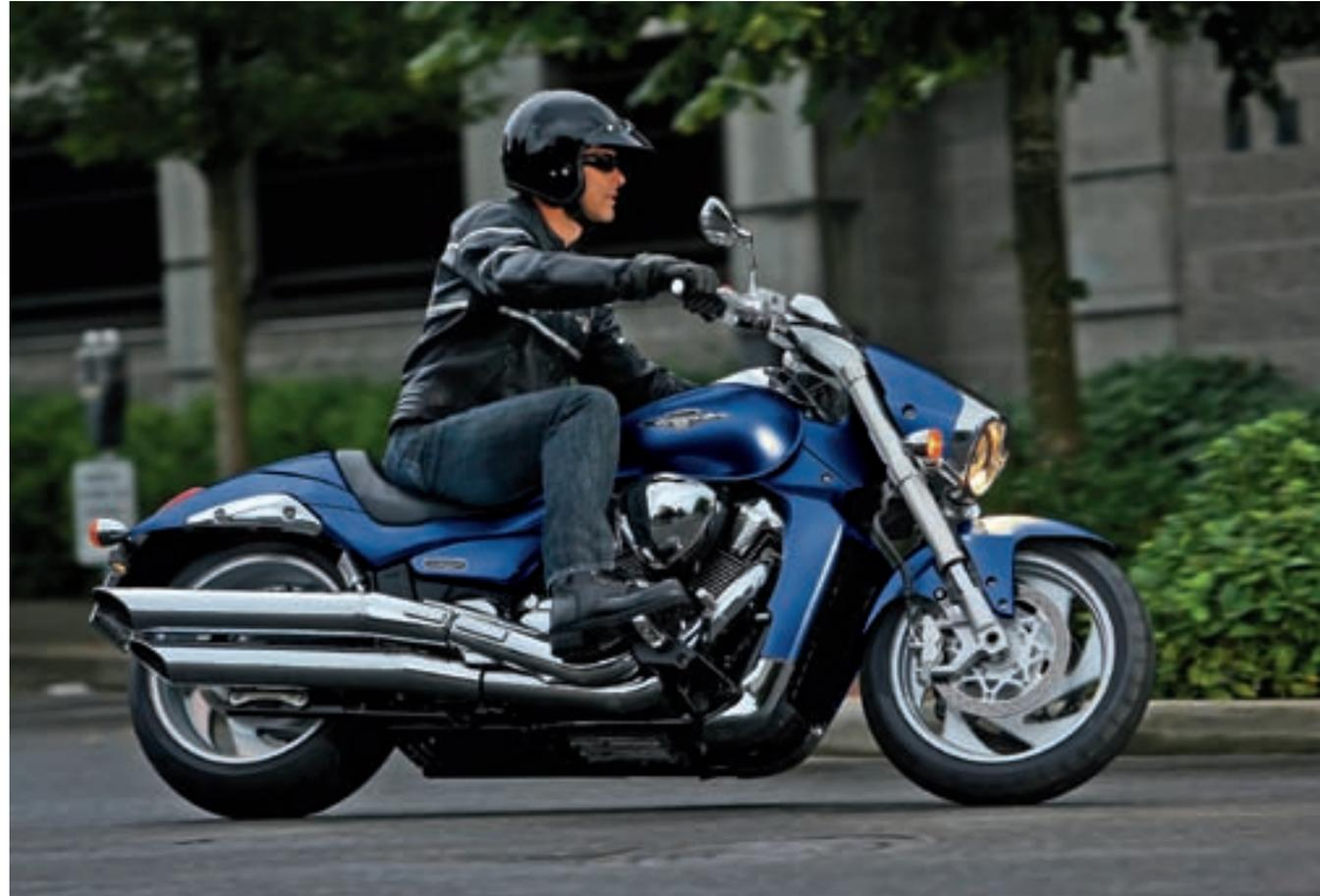
**Die Intruder M1800R ist ein echter Power-Cruiser** mit einem der stärksten V-Twin Motoren, die jemals gebaut wurden. Zwei Zündkerzen pro Zylinder und ein digitales Motormanagement unterstützen die explosive Beschleunigung, butterweiche Gasannahme und das Drehmoment mit Lächelgarantie (160 Nm/3200 min<sup>-1</sup>). 2010 gleitet die M1800R in Schwarz und Blau dahin.
