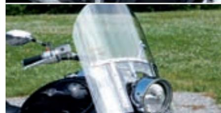
**Hohe Cruiserscheibe** für optimalen Wind- und Wetterschutz inklusive Beinschild. Entlastet deutlich vom Winddruck und sorgt für entspanntes Touren. Geräusche und Verwirbelungen werden auf ein Minimum reduziert.
