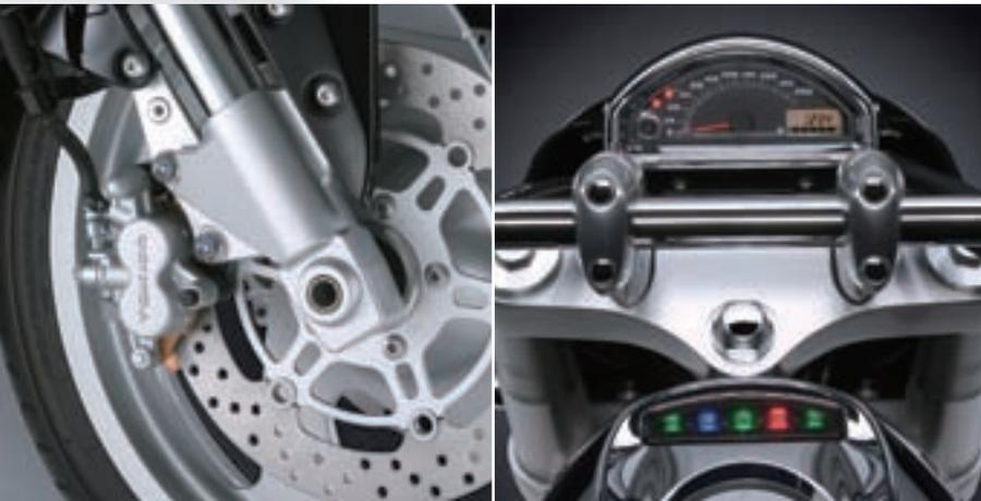
**Auch bei den Details wird geklotzt.** Die M1500 rollt mit einer 43 mm Teleskopgabel durchs Leben, vorne wird mit einer 290 mm Doppel-Scheibenbremse verzögert, hinten unterstützt eine 275 mm Einzelscheibe. Das Cockpit setzt auf große, gut ablesbare Instrumente.
